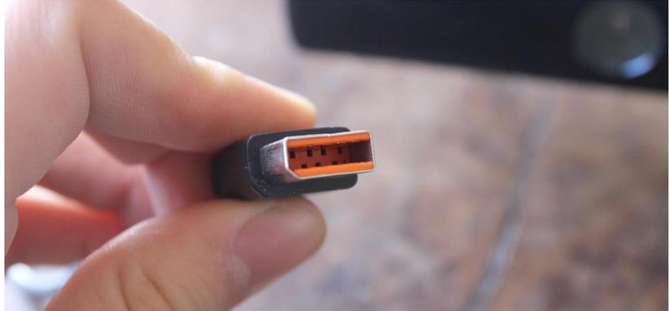
Este adaptador está provisto de una ficha hembra, a la que se insertará el conector único de Kinect, y dos salidas macho, una USB para datos y una fuente transformadora eléctrica.
